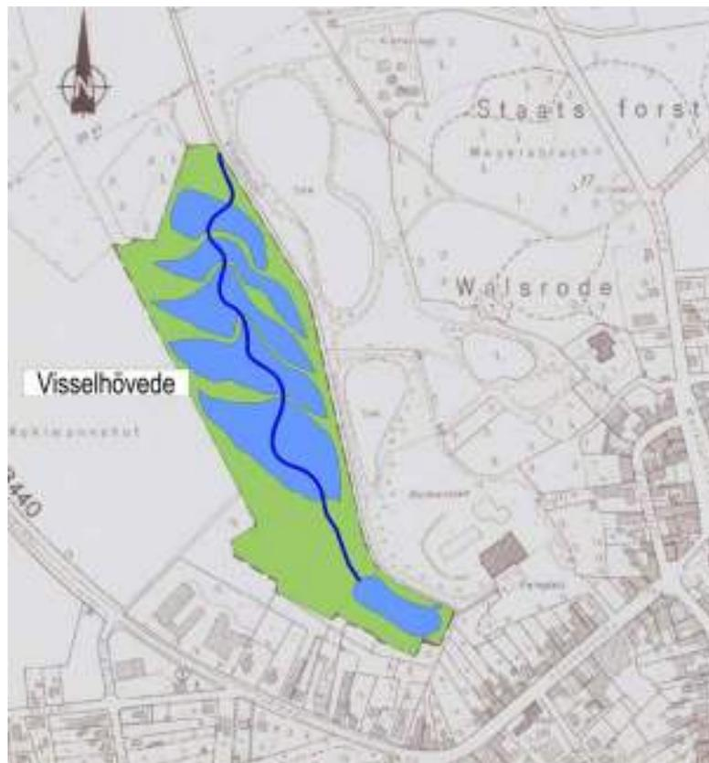
Abb. 9-72: Übersichtsplan des Regenrückhaltebeckens Visselhövede [IDN, 1997]
