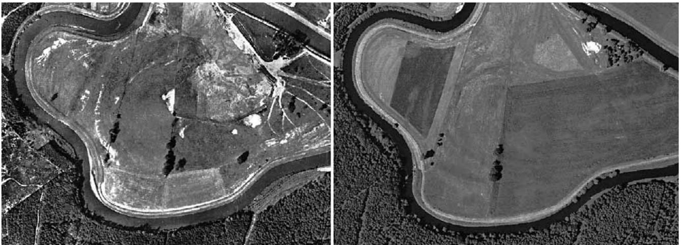
Abb. 2: Im Luftbildvergleich gut sichtbare Strukturverluste durch Nutzungsänderung und Flurbereinigung nach Eindeichung und Kanalisierung der Hase zwischen 1956 und 1995 (Flusschleife der Haase südwestlich von Haselünne). (1956: mit freundlicher Genehmigung der Hansa Luftbild AG.)
